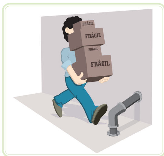
Figura 1.2: Ato (carregar itens acima de sua capacidade) + condição insegura (obstáculos)
